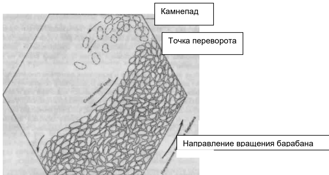
Рис.7. Поведение абразива в галтовочном барабане
